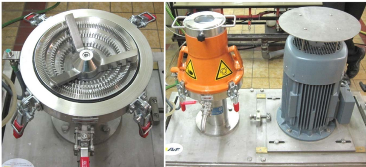
Abbildung 3-1: Disperger CaviMix 1032. Links: Detailansicht Rotor. Rechts: Gesamtübersicht mit geschlossenem Deckel [55].
